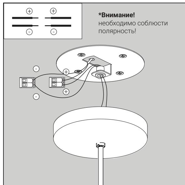
Проденьте кабель светового модуля через центральное отверстие потолочного крепления. С помощью клемм (поз.6) подключите его к питающему кабелю, соблюдая полярность.
