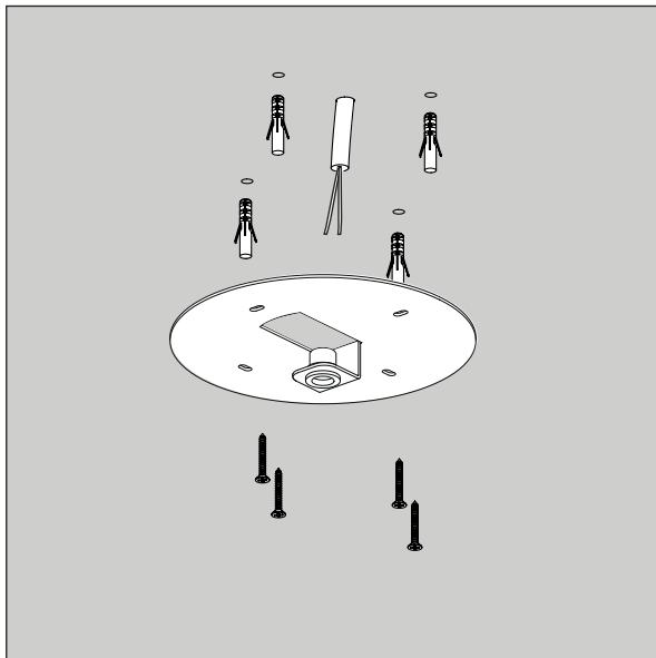
С помощью дюбелей и саморезов (не входят в комплект поставки) установите крепление (поз. 3).
