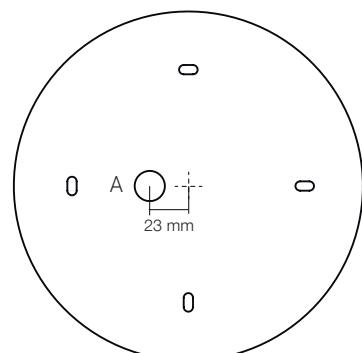
С помощью шаблона, идущего в комплекте (поз. 7), сделайте разметку отверстий крепления. Кабель питания должен пройти в отверстие А. Просверлите отверстия.
