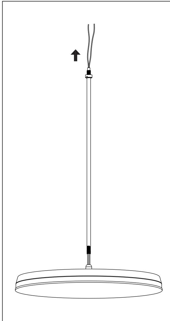
Проденьте кабель светового модуля светильника EVO Move (поз. 2) через штангу (поз.5) так, чтобы стопорная гайка оказалась сверху.
